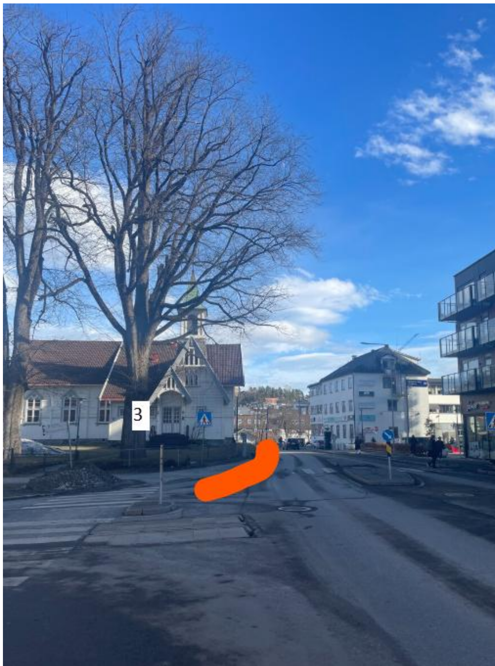
Figur 7 Tre 3 foran den historiske bygningen ved Elias Smiths vei. Planlagt åpen graving (markert med oransje) går rett inn i rotsonen til treet, som har stor visuell verdi og betydelig størrelse. Det er høy risiko for alvorlig rotskade. En vurdering må gjøres i felt ved eksponering.
